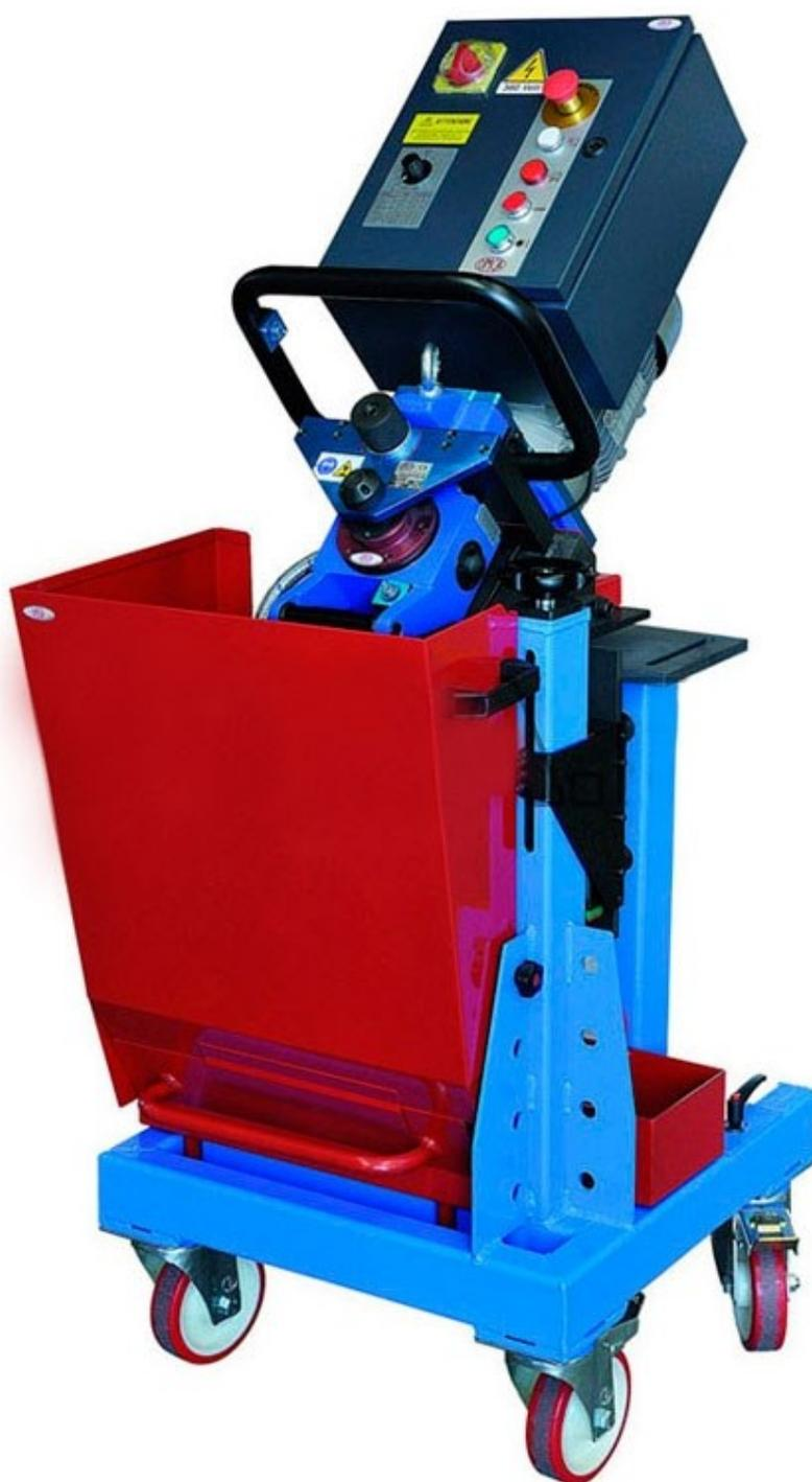
СМФ 900 - машина для снятия фаски с автоматической подачей предназначена для обработки кромки листовых материалов под сварку. Подача обрабатываемых заготовок малого и среднего размера в зону реза фрезы производится автоматически с помощью подающих роликов, при обработке заготовок большого размера машина самостоятельно перемещается по листу. Возможна работа без колесной базы (тележки) с подачей машины на балансире.
