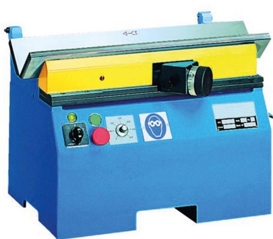
Настольная кромкофрезерная машина МФ 850 позволяет производить зачистку, торцевание и снятие фаски с наружных прямолинейных поверхностей.
