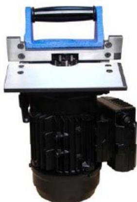
**Приспособление для торцевания.** Используя специальное приспособление, устанавливаемое вместо меньшей направляющей, можно выполнять торцевание кромки, т.е. обработку под прямым углом.
