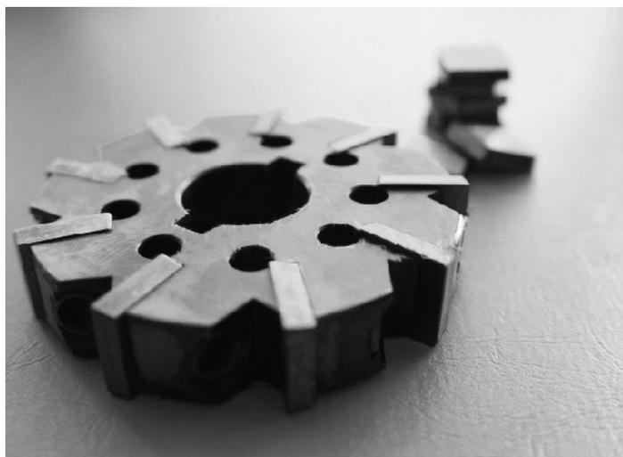
Для обработки нержавеющей стали и других сплавов с повышенными прочностными характеристиками рекомендуется использовать специальную фрезерную головку, состоящую из трех фрез.
