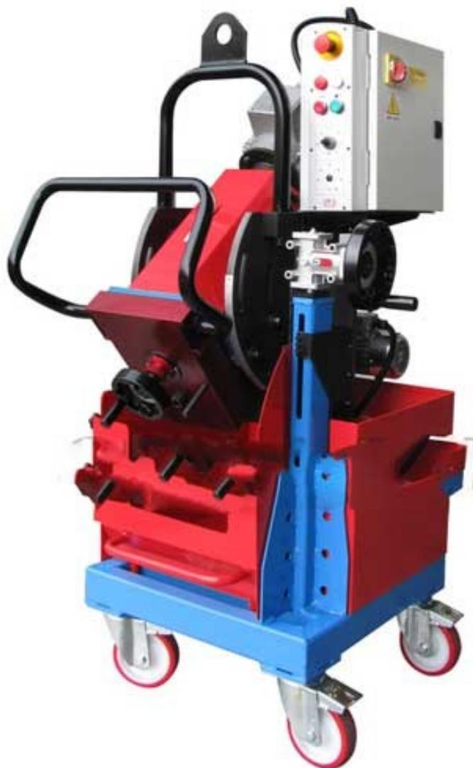
Машина для снятия фаски с автоматической подачей СМФ930 представляет собой "перевернутый" вариант машины для снятия фаски с автоматической подачей СМФ900 и предназначена для снятия фаски с нижней поверхности листа без трудоемких манипуляций с заготовкой и возможностью торцевания (разделки кромки под углом 0°).
