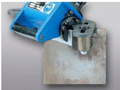
**Приспособление для обработки торцов труб.** Устройство предназначено для обработки внешних кромок фланцев и труб с минимальным Ø150 мм. В соответствии с расположением трубы (горизонтальным или вертикальным) заменяет собой одну из двух направляющих машины. Для машин МФ 700М, МФ 750М и МФ 760М.
