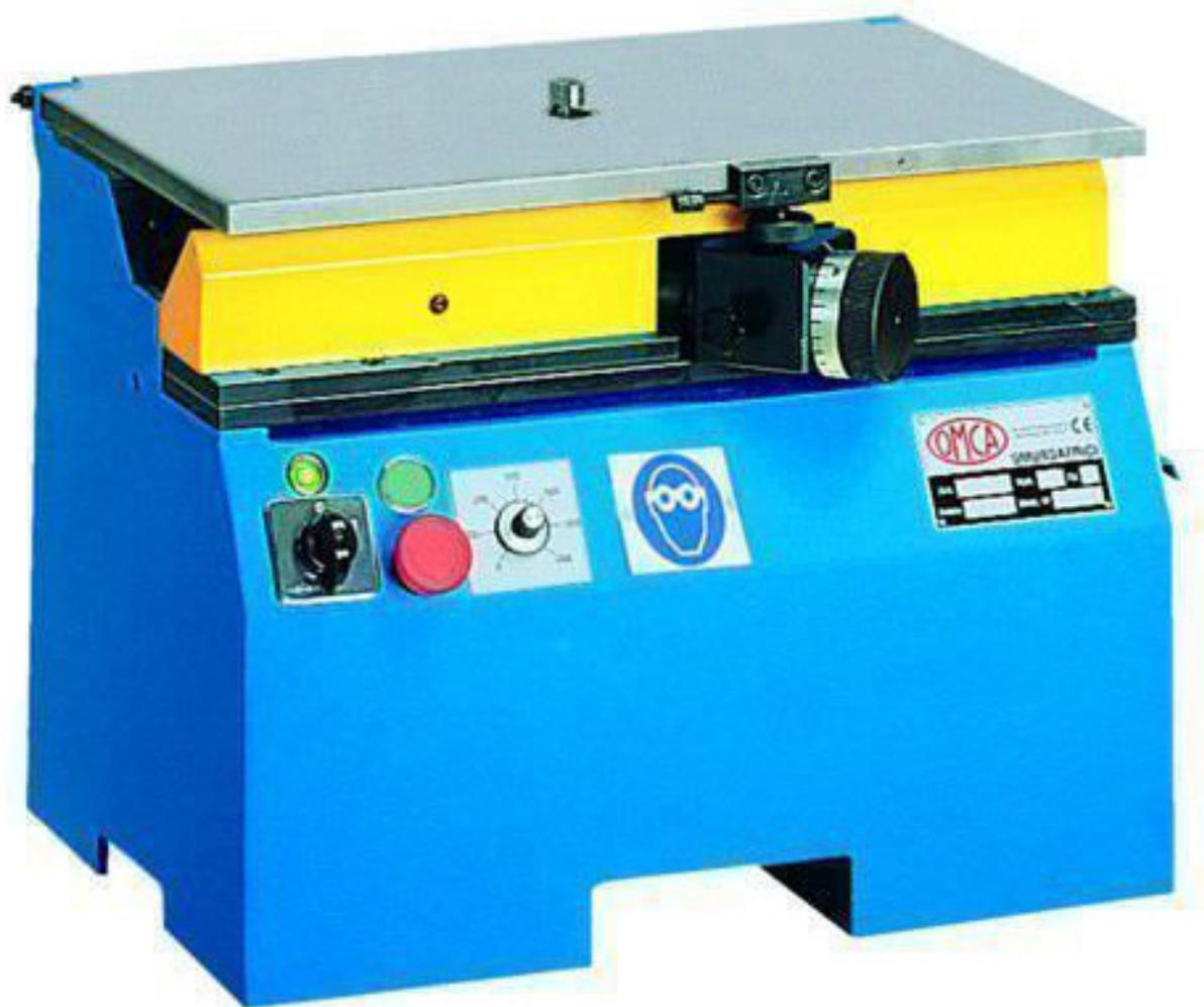
Настольная кромкофрезерная машина МФ 810 позволяет производить зачистку, торцевание и снятие фаски с внутренних и наружных поверхностей прямых и радиусных кромок.
