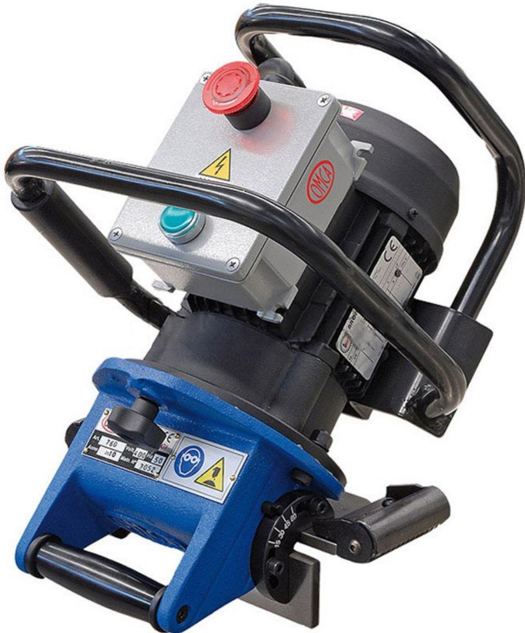
Ручной кромкорез МФ 760М /MF 760М (пр-во OMCA, Италия) – универсальный станок для снятия фаски с листов металла и торцов труб.
