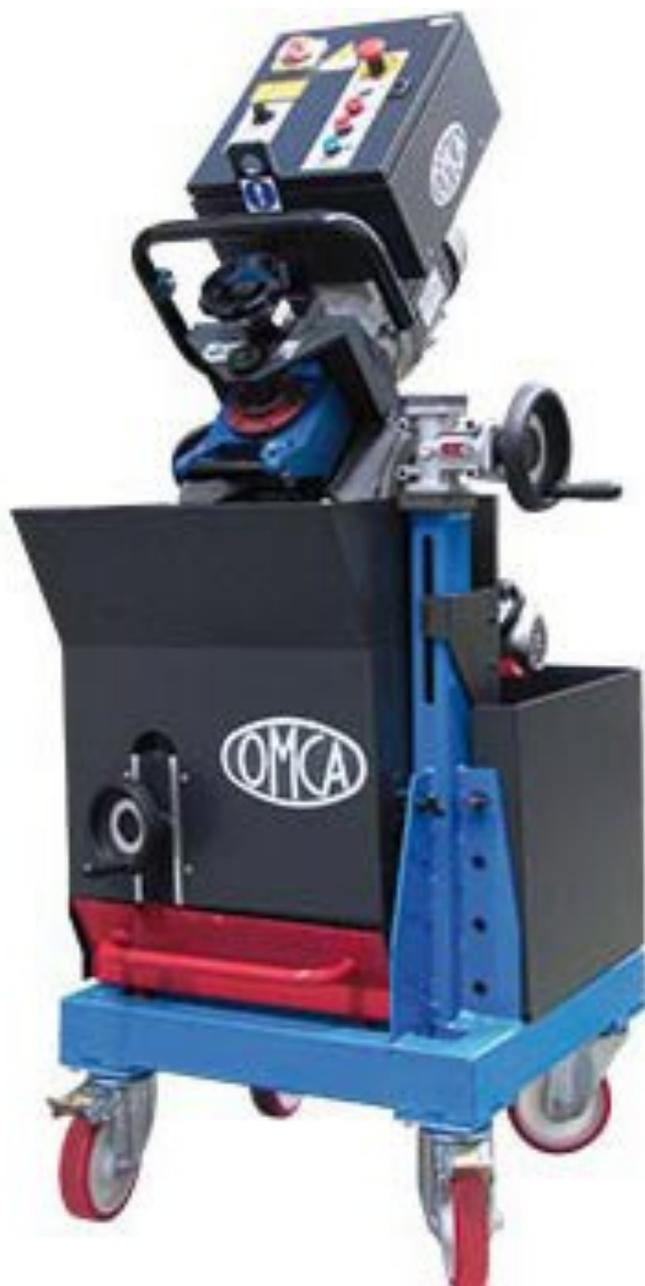
СМФ 900 PLUS - машина для снятия фаски с автоматической подачей предназначена для обработки кромки листовых материалов под сварку. Подача обрабатываемых заготовок малого и среднего размера в зону реза фрезы производится автоматически с помощью подающих роликов, при обработке заготовок большого размера машина самостоятельно перемещается по листу. Возможна работа без колесной базы (тележки) с подачей машины на балансире.
