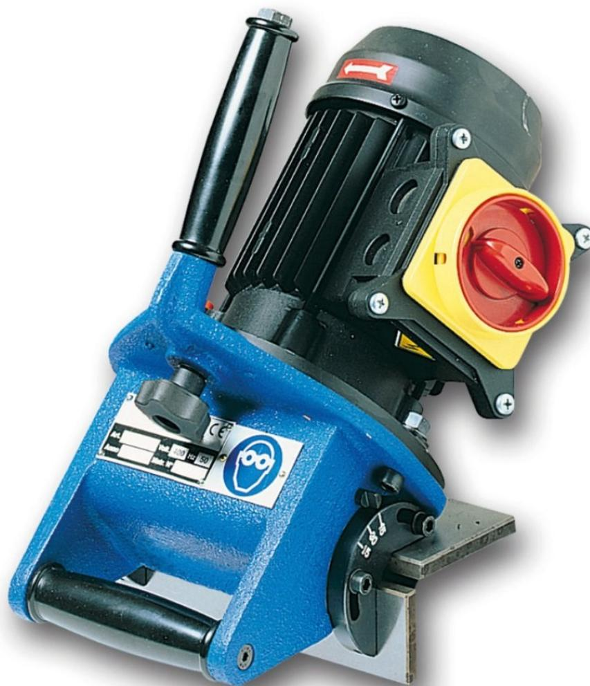
Ручной кромкорез МФ 700М (пр-во OMCA, Италия) – универсальный кромкофрезерный агрегат для снятия фаски с листов металла и торцов труб.
