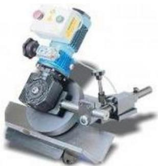
Устройство автоматической подачи для настольных станков моделей: МФ 810, МФ 650А/ L и МФ 650А/ S и L/ S. Крепится на рабочей поверхности настольных станков и позволяет обеспечить автоматическую подачу заготовок со скоростью от 0,3 до 1,2 м/мин. в процессе обработки.
