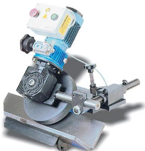
**Устройство автоматической подачи** для настольных станков моделей: МФ 810, МФ 650A/ L и МФ 650A/S и L/S. Крепится на рабочей поверхности настольных станков и позволяет обеспечить автоматическую подачу заготовок со скоростью от 0,3 до 1,2 м/мин. в процессе обработки.
