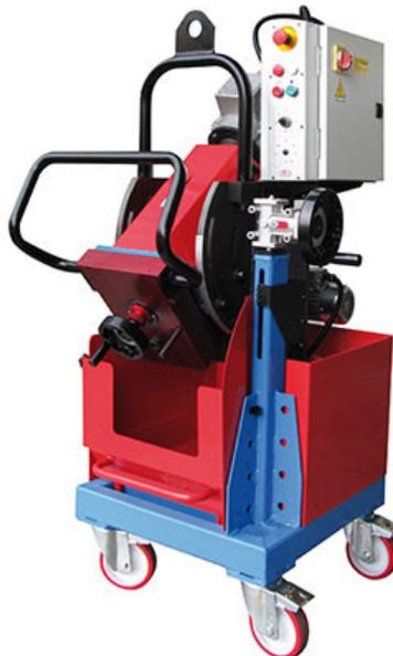
Машина для снятия фаски SMF-930 Reverse представляет собой перевернутую модель SMF-900 и позволяет снимать фаску с нижней кромки листа, что бывает удобно в случаях, когда размеры заготовки слишком велики для манипуляций. Также станок пригоден для торцевания кромок, то есть снятия фаски под углом  $0^\circ$ . Устройство автоподачи при помощи роликов перемещает заготовку в зону обработки, а в случае мобильного использования - перемещает станок по кромке листа.
