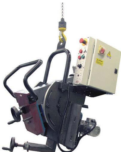
Метод снятия фаски - фрезерование на высокой скорости при помощи фрезеровательной головки, что обеспечивает высокое качество поверхности фаски. Твердосплавные пластины, установленные на фрезе, легко заменяются по мере износа. Если фаска снимается за несколько проходов - каждый следующий проход следует уменьшать глубину подачи.
